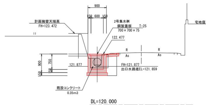
重圧管布設工詳細図
